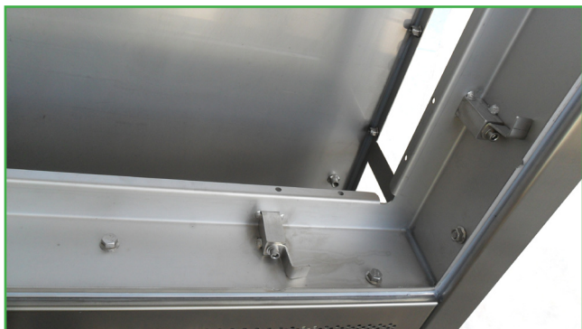
Piano di battuta filtri in pezzo unico (tenuta meccanica)
